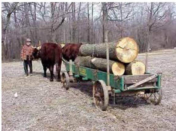
Wagen mit Stahlrädern zum Transport von Baumstämmen. Stahlräder verursachen höhere Zugkräfte als Luftreifen
