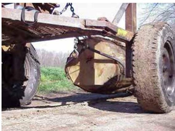
Kurz angehängt hebt ein Rückewagen das Vorderende des Stammes vom Boden weg, hält so den Stamm sauber und reduziert den Zugkraftbedarf.
